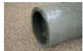
Rohr mit beschädigter Oberfläche
