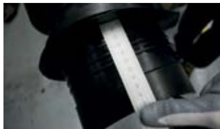
Schraubkragen entsprechend der Wandstärke einstellen
